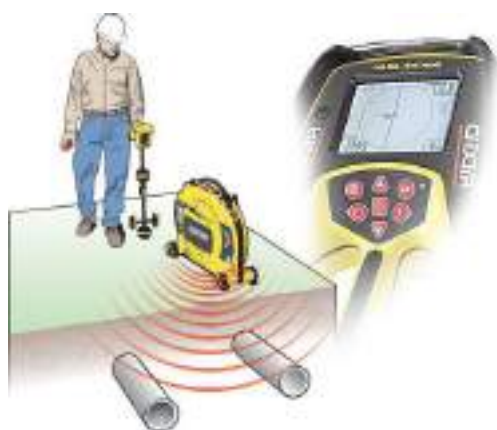
Рис. 4. Бесконтактный метод поиска токопроводящих коммуникаций «RIDGID SR-20»;
