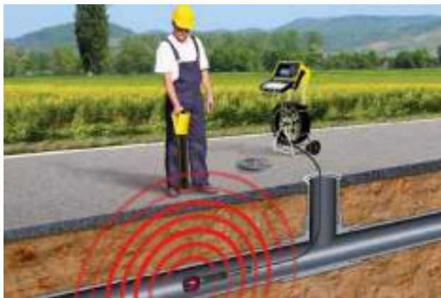
Рис. 6. Метод дополнительного проводника;
