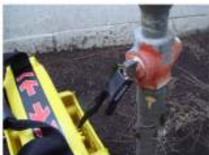
Рис.5. Контактный метод поиска токопроводящих коммуникаций «RIDGID SR-20»;
